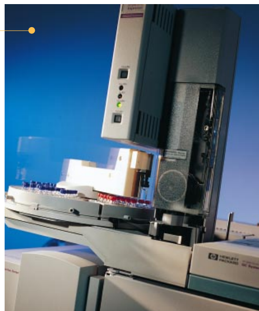
Automaattinen näytteensyöttäjä yhdistetystä kaasukromatografi-massaspektrometristä. Laitetta käytetään erilaisten yhdisteiden rakenteen selvittämiseen ja muun muassa sterolien tunnistamiseen.
