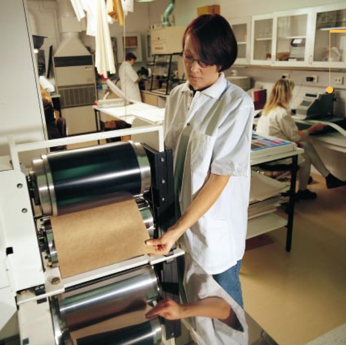
Laboratoriokalenterilla jäljitellään paperiin tuotanto-olosuhteissa saatavaa kiiltoa ja sileyttä. Työssä on laborantti Eveliina Hopeanaula.
