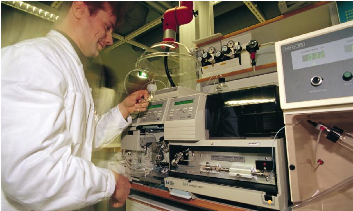
Benecol-liiketoiminta sai lokakuussa 1997 uudet laboratoriotilat Raisioon valmistuneesta tutkimus- ja kehityskeskuksesta. Tutkimusapulainen Jari Palin työskentelee nestekromatografilla, jota käytetään muun muassa kasviesterolien määrittämenetelmien kehittämiseen.
