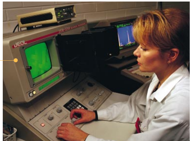
Laborantti Virpi Tuominen työskentelee elektronimikroskoopilla (SEM/EDXRF), jota käytetään muun muassa paperin pinnan tutkimiseen.
