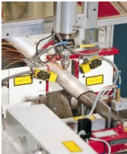
Ja-Ro:n Pietarsaaren tehtaalla otettiin loppuvuodesta 1996 tuotantokäyttöön uusi nopea ja tarkka laserhitsaus/leikkaus -linja.
