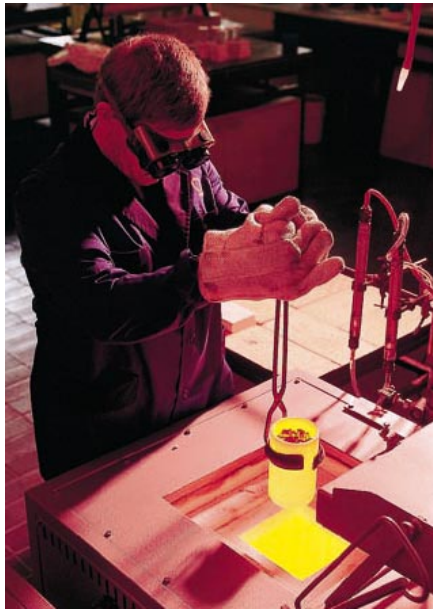
Toiminnan tehostaminen niin omassa tuotannossa kuin asiakkaille myytävän teknologian osalta ohjaa tuotantoteknologioiden kehittämistä. Kuvassa suoritetaan korkeiden lämpötilojen pyrometallurgista koetta.
