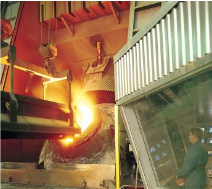
Tornion terässulaton kromikonvertteri mahdollistaa lähes kaiken ferrokromin panostamisen sulassa muodossa. Kuvassa konvertteriin syötetään romua, joka on kromin ja nikkelin ohella ruostumattoman teräksen tärkeä raaka-aine.
