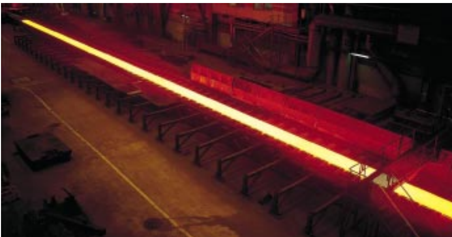
Näyttävien vaihe ruostumattoman teräksen tuotannossa on kuumavalssaus. Kuvassa noin 8 mm:iin valssattu kuumanauha on siirtymässä loppukelaimelle.
