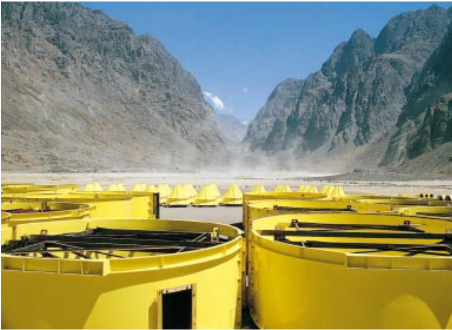
Outokumpu on markkinajohtaja vaahdotusteknologian alalla. Vuonna 1996 vaahdotuskennoja myytiin ennätysmäärä, etenkin Etelä-Amerikkaan. Yllä 32 OK-100-TC -tankkikennoa odottamassa asennusta Codelcon Andinan kaivoksella ja alla Escondida-kaivoksen rikastamo, molemmat Chilessä.
