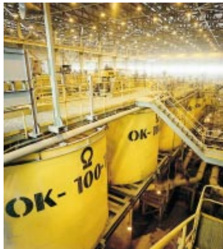
Outokumpu on markkinajohtaja vaahdotusteknologian alalla. Vuonna 1996 vaahdotuskennoja myytiin ennätysmäärä, etenkin Etelä-Amerikkaan. Yllä 32 OK-100-TC -tankkikennoa odottamassa asennusta Codelcon Andinan kaivoksella ja alla Escondida-kaivoksen rikastamo, molemmat Chilessä.
