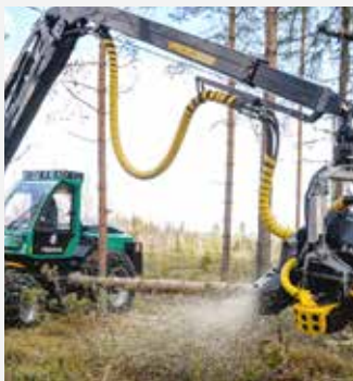
Kesla lanseerasi vuonna 2021 syksyllä III-sukupolven rullakourat. Kuvassa kaivinkoneasenteinen KESLA 24RH-III.
