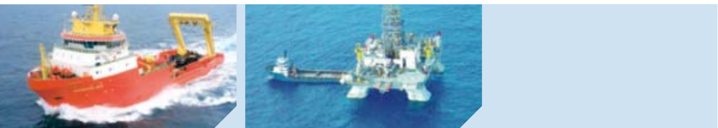
Vasemmalla: Normand Ivan -kalastusaluksessa on Wärtsilän propulsiopaketti: moottorit, potkurit, vaihdelaatikot ja valvontajärjestelmä. Oikealla: Miss Jane Tyde öljynporauslautassa on Lipsin potkurilaite.
