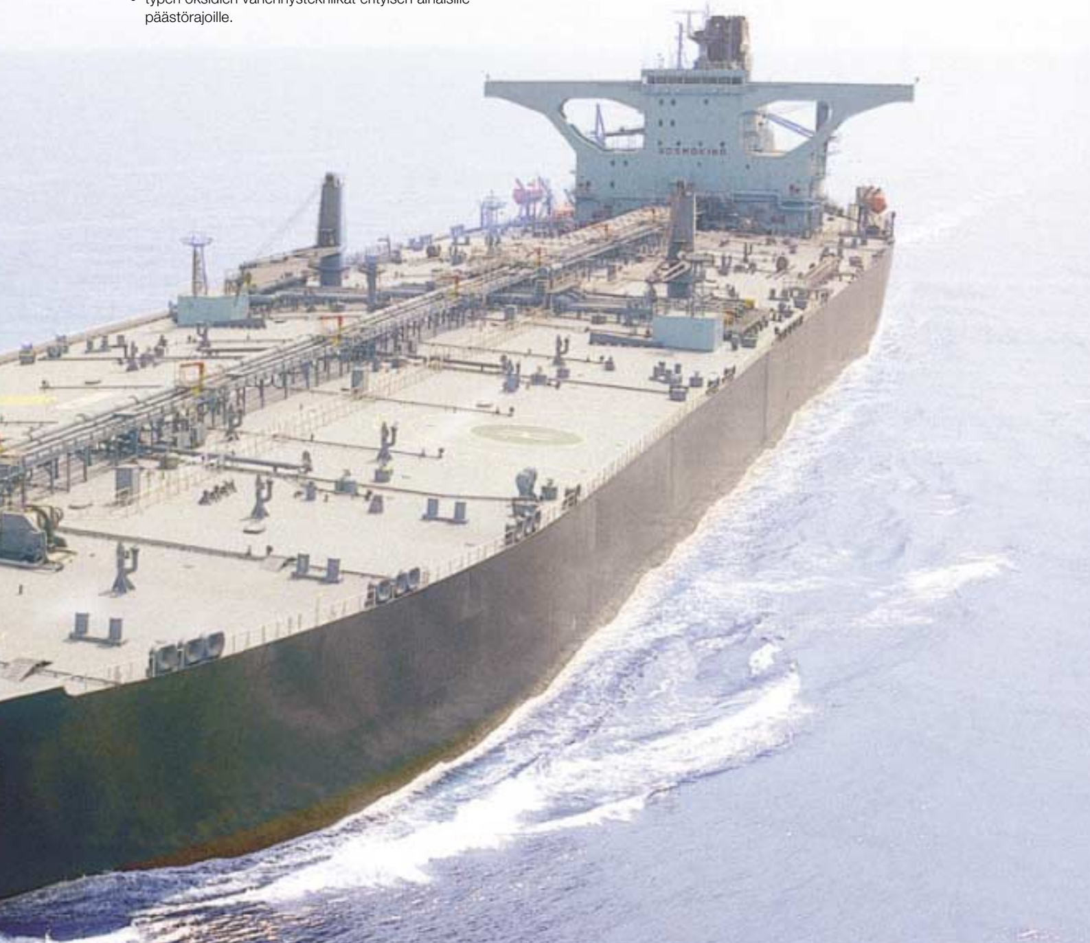
Öljytankkeri Kestrel, jonka voimanlähteenä on Sulzer 7RTA84T-B-moottori.
