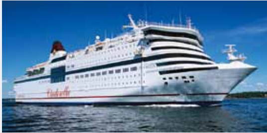
VIKING CINDERELLA Toim. 1989 • BRT 46 398 • Pituus 191,0 m • Jäätaluokka I A Super 2 560 matkustajaa • 306 henkilöautoa • 2 500 vuodepaikkaa Tukholma–Maarianhamina • Ruotsin lippu
