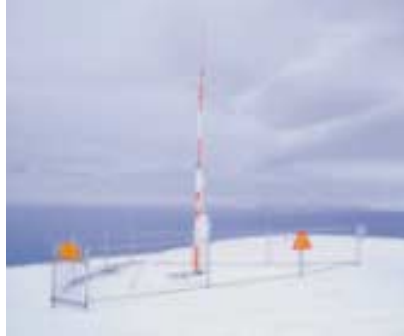
Vaisalan AW11-järjestelmä on automaattinen sääasema, joka täyttää pien- ja helikopterikenttien säähavaintotarpeet.
