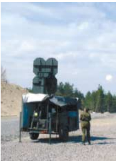
Vaisalan RT20-radioteodoliitti on passiivinen ja itsenäinen järjestelmä.
