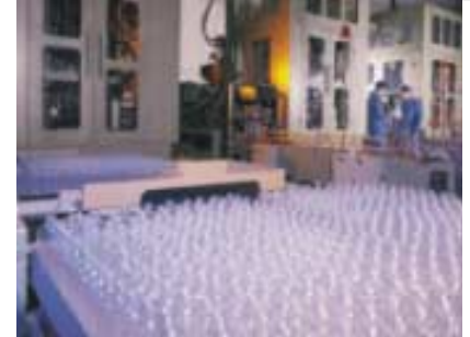
Muovin muovausta edeltävä kuivausvaihe on eräs tyypillinen kastepistemittauksen sovellus. Liiallinen kosteus muovauksen aikana aiheuttaa laatuviokoja lopputuotteisiin.
