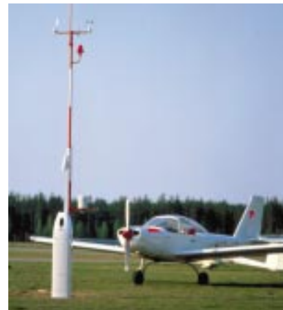
Vaisalan AW11-järjestelmä on pienikokoinen ilmailusääjärjestelmä, joka mittaa lentosääolot ja raportoi ne lentäjille.
