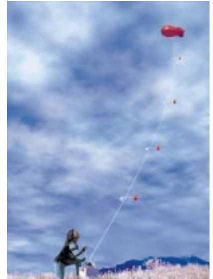
Vaisalan kiintosondijärjestelmää käytetään ilmakehän rajakerroksen mittaukseen.
