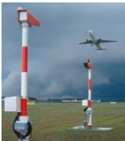
Vaisalan MITRAS-järjestelmä on hyväksytty ratkaisuna kiitoteiden näkyvyysmittaukseen.
