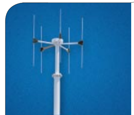
SAFIR-järjestelmä tuottaa kattavaa tietoa ukkosista: se paikantaa salamät ja antaa tarkkaa tietoa niiden ominaisuuksista.
