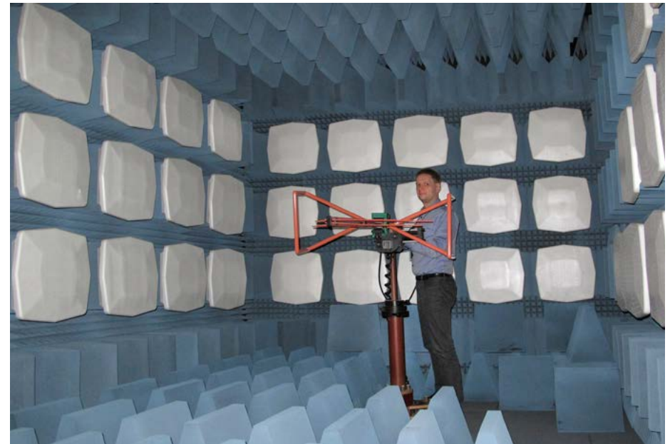
Tuotekehityssuunnittelija Mikko Nurminen Telesteltä on tekemässä EMC-mittauksia Turun ammattikorkeakoulun laboratoriotiloissa.
