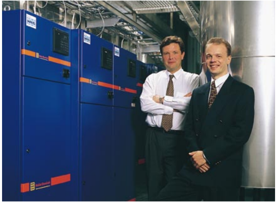
Raisio Chemicals kehitti WIC 100 -mittausjärjestelmän, jolla kyetään analysoimaan paperikoneen märkäosan kemiallisia ja fysikaalisia suureita. Kuvassa ovat tuoteryhmäpäällikkö Claes Zetter (vasemmalla) ja myyntipäällikkö Petri Pursibeimo.
