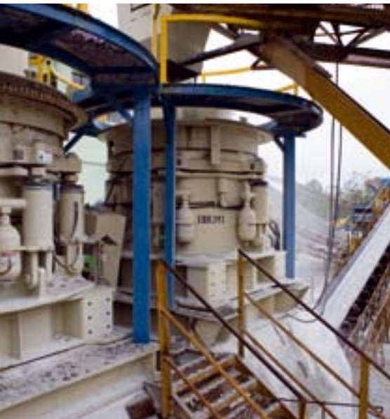
Pedreiras Basalton louhos São Paulon lähistöllä Brasiliassa ja Metso Mineralsin toimittama kartiomurskain.
