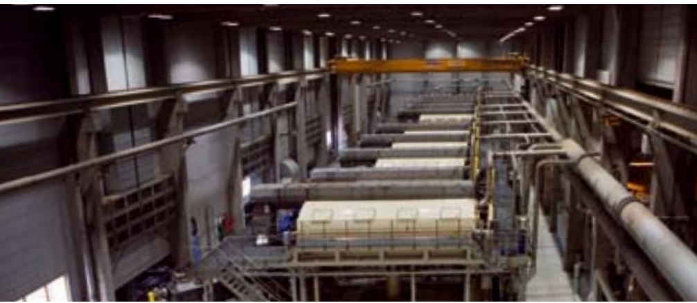
Kuitulinjan Twinroll-pesupuristimet Zellstoff Stendalin tehtaassa Saksassa. Metso on toimittanut tehtaaseen koko sellunvalmistuslinjan puun käsittelystä valmiin massan paalaukseen.
