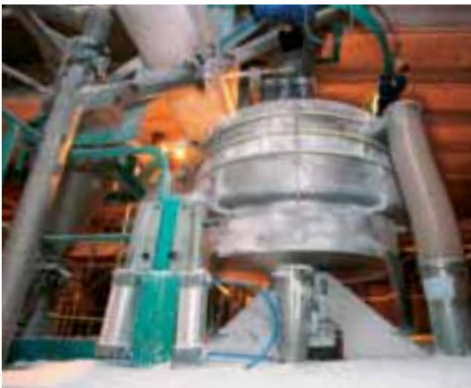
Natriumperkarbonaattirakeet seuloutuvat oikean kokoisiksi.
