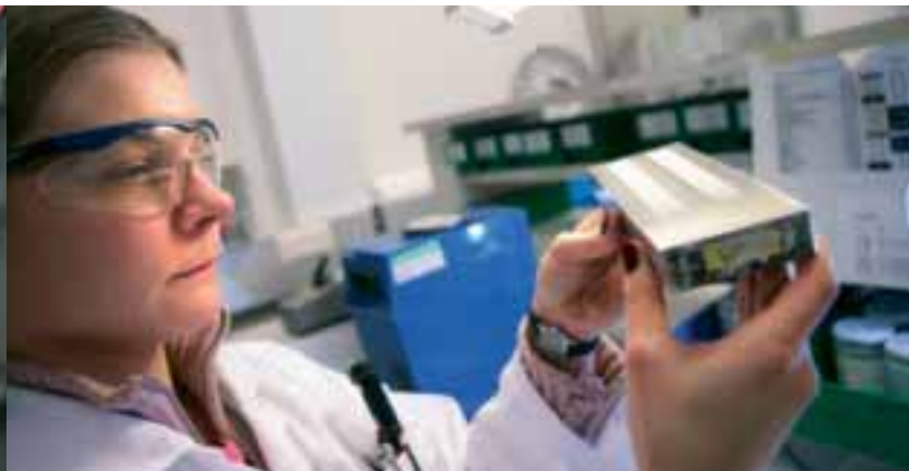
Päivi Syrjälä mittaa grindometrillä maalin hienousastetta.
