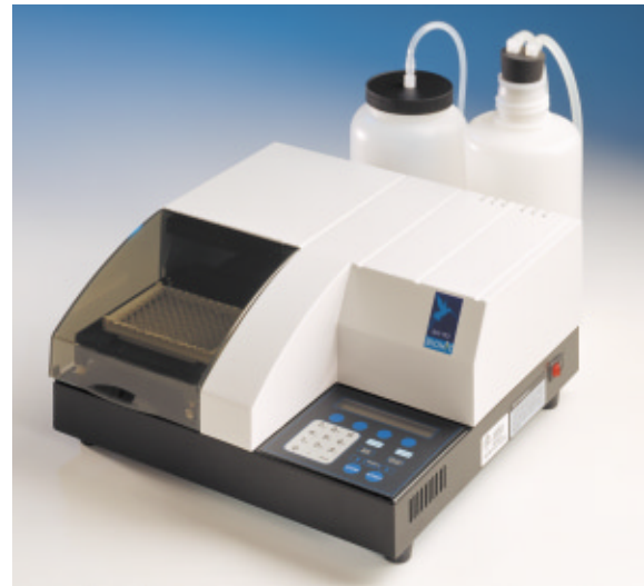
Biohitin mikrolevykeskus, joka soveltuu tarkan pumpun ansiosta käytettäväksi myös nopeana nesteannostelijana.
